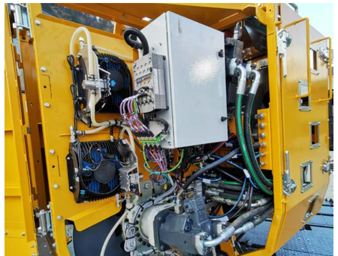
Hohe Wartungsfreundlichkeit durch gut zugängliche Technik in ergonomischer Arbeitshöhe
